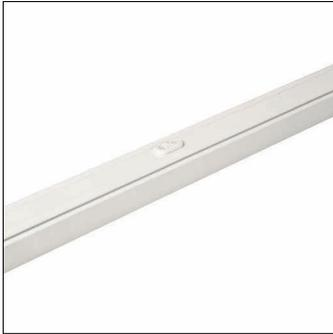
Modario®, zusätzliche Einspeisung, Verdrahtung, mit 20x Klemme 2-fach 1,5..2,5mm<sup>2</sup>, für Einspeisung, Durchverdrahtung: 10x 2,5mm<sup>2</sup>, Tragschienen-Element, aus Stahl, lackiert, leuchtenweiß, 5x Systemmaß, Länge: 1.495mm, Breite: 58mm, Höhe: 43mm, Schutzart (gesamt): für Schutzart IP20, Schutzklasse (gesamt): SK I (Schutzerdung), Prüfzeichen: CE, UKCA, Verpackungseinheit: 1 Stück
