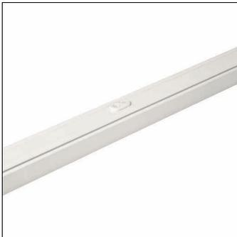
Zubehör Gehäuse, für Modario® IP64, Tragschiene, zusätzliche Ein-/Auspeisung, aus Stahl, verzinkt, lackiert, leuchtenweiß, 5x Systemmaß, Länge: 1.495 mm, Breite: 58 mm, Höhe: 43mm, Durchverdrahtung: 10x 2,5mm<sup>2</sup>, Schutzart (gesamt): für Schutzart IP64, Schutzklasse (gesamt): SK I (Schutzerdung), Prüfzeichen: CE, UKCA, Verpackungseinheit: 1 Stück
