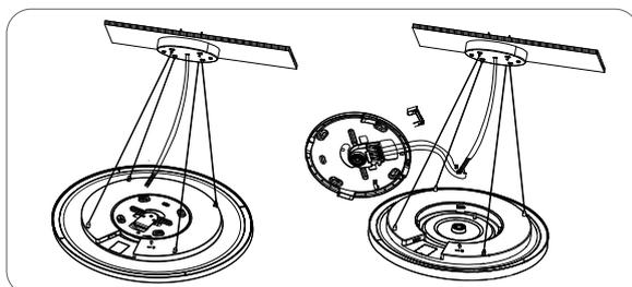
5. Öffnen Sie die Montageplatte der Leuchte, indem Sie diese gegen den Uhrzeigersinn drehen. Schließen Sie das 230V-Kabel an der Klemme an.
