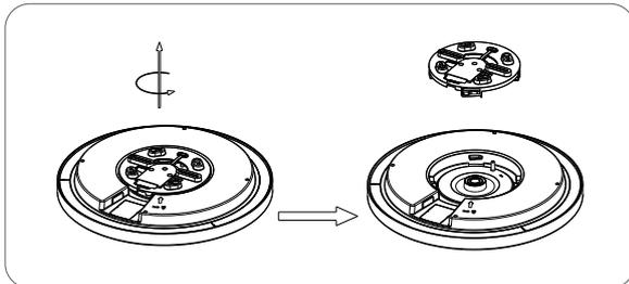
1. Drehen Sie die Montageplatte gegen den Uhrzeigersinn, um diese zu entfernen.
