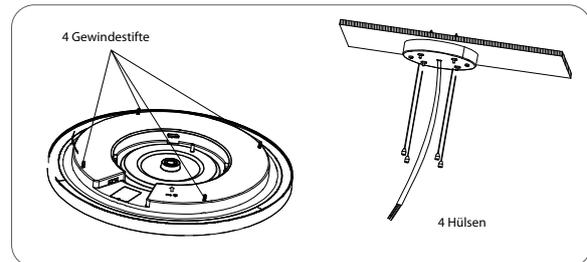
4. Fixieren Sie die 4 Gewindestifte in der Leuchte und drehen Sie im Anschluss die Hülsen an den Stahlseilen auf den Gewindestift bis diese fest sitzen.
