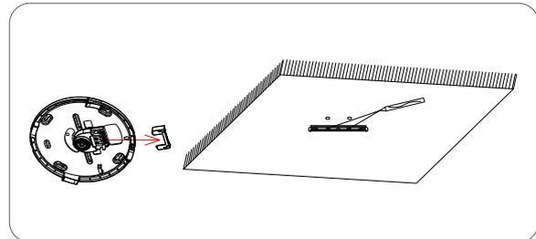
2. Entfernen Sie die Klemmenabdeckung und markieren Sie die Montagelöcher des Baldachins.
