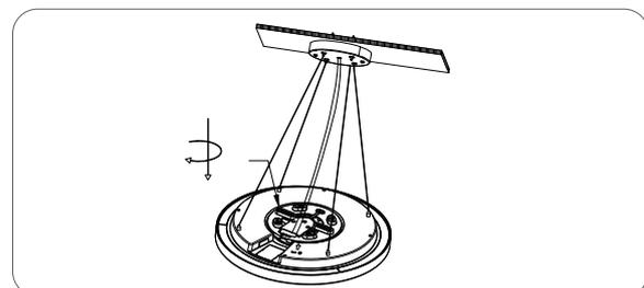
6. Schließen Sie die Montageplatte durch Drehen im Uhrzeigersinn an die Leuchte an und prüfen Sie diese auf Stabilität.
