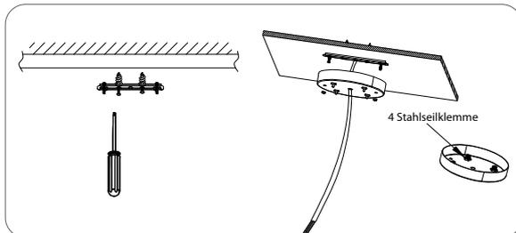
3. Befestigen Sie die Montageplatte mit den Schrauben an der Decke. Schließen Sie die 230V Anschlussleitung aus ihrer Decke an die Schraubklemme im Baldachin an. Im Anschluss schließen Sie ebenfalls, das im Lieferumfang enthaltene transparente Kabel an die Schraubklemme an.
