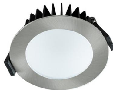
Tunable-White Einbauleuchte für verschiedene Anwendungsbereiche, wie z. B. flächendeckende, aber auch effektvolle Beleuchtungen in Flur, Wohnzimmer, Büro, und vieles mehr. Die Farbtemperatur der Leuchte kann mittels separat erhältlichen Controller im Bereich von 2700K-6500K frei gewählt werden. Die angegebenen Lumen (1350lm) werden bei 6500K erreicht, während im Betrieb von 2700K max. 1250lm erreicht werden. Die Anschlussleitung hat eine Länge von 27cm. Max. tc: 68°C.
